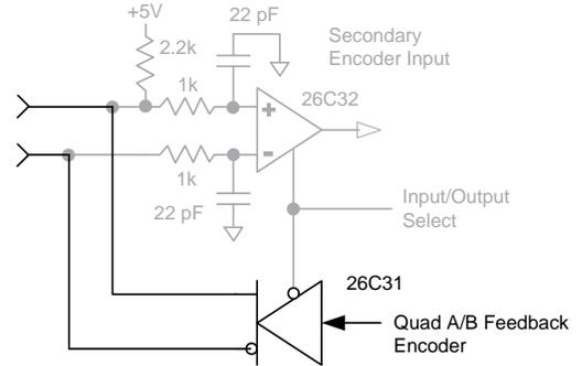
AS EMULATED QUAD A/B/X ENCODER OUTPUTS FROM AN ANALOG SIN/COS FEEDBACK ENCODER
